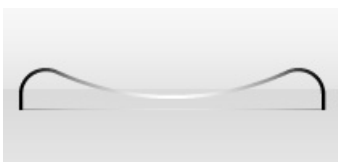
Difusorové dno (max. Ø4300 – síla stěny max.50mm)
