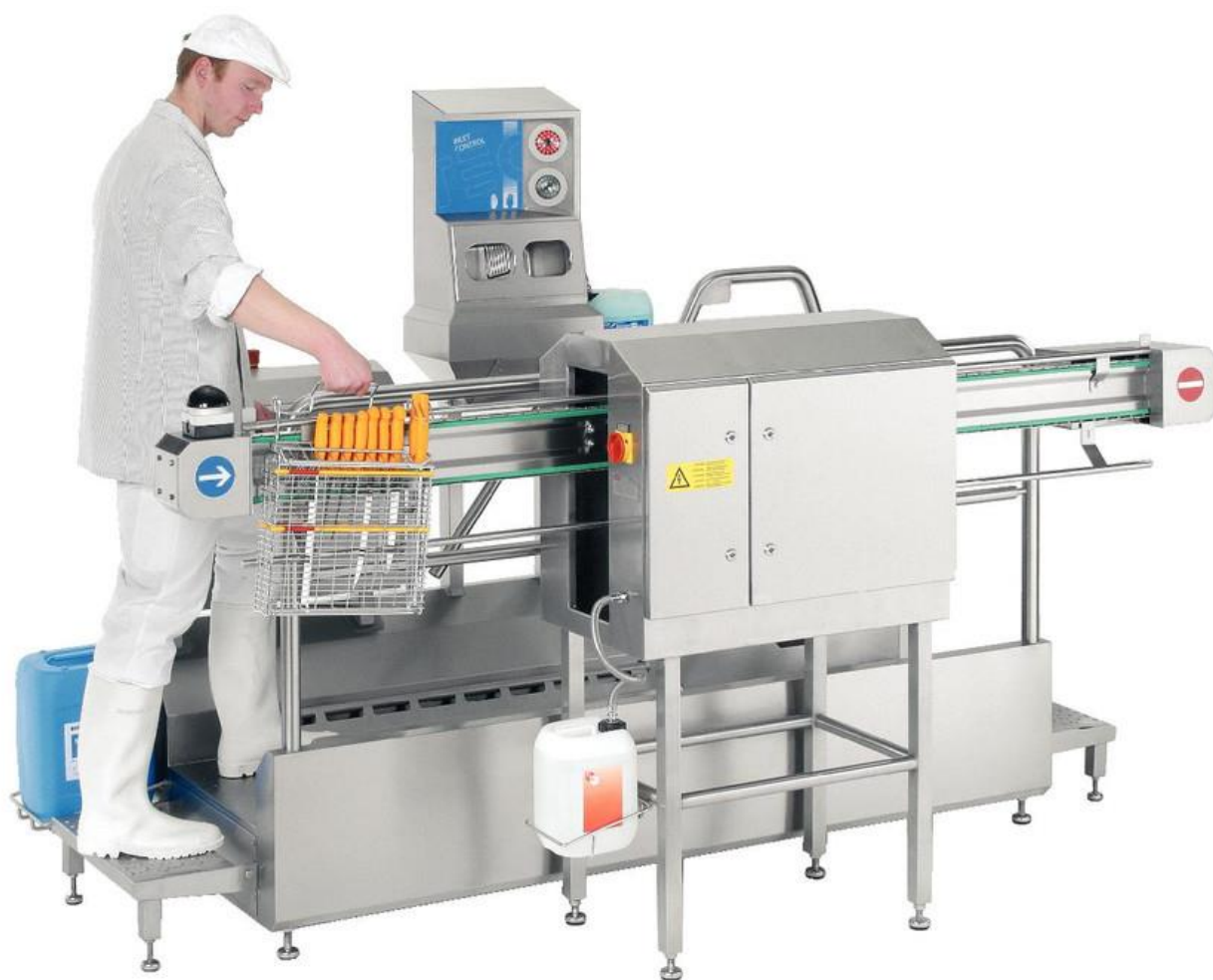
Typ 22400 Dezinfekce nožů před vstupem do výroby
