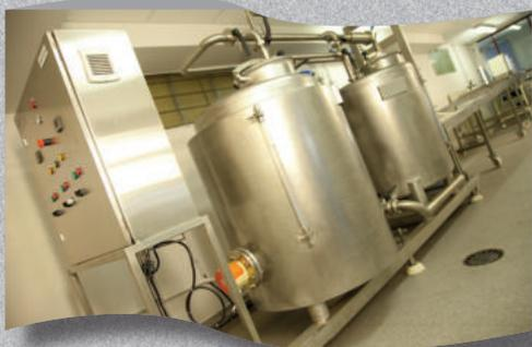
La société Gecitech est équipée d'une station de lavage intérieur des flexibles par eau chaude adoucie, rinçage en eau osmosée et séchage par circulation d'air chaud filtré. Cette possibilité de nettoyage est proposée en option sur demande du client.
