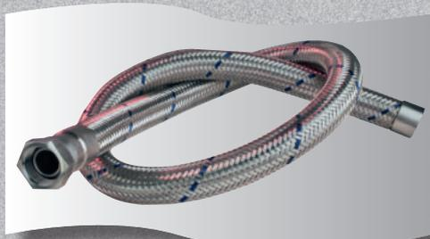
Tresse en acier inoxydable 304L avec revêtement intérieur en acier inoxydable 316L (formage mécanique ou hydroformé).
