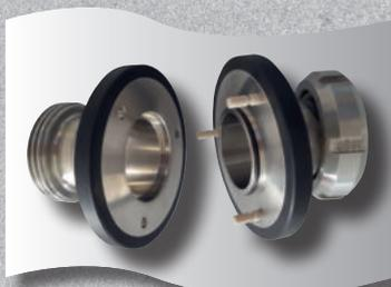
Le raccord CRT (Coupleur à Rupture sous Traction) est conçu pour se désaccoupler lorsqu'il est soumis à une forte traction, dans le cas de déplacement d'équipements mobiles toujours raccordés à l'installation.
